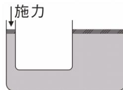
34. 一個熱水瓶，欲使瓶內的水流出，應按上方壓盤，將空氣打入瓶內，使瓶內的氣壓比外界氣壓大。當盛滿水的時候，水位可高到 a 處，現在只裝到 c 處(如右圖所示)。若要將瓶內的水壓出來，則瓶內的氣壓至少比瓶外氣壓大多少？
